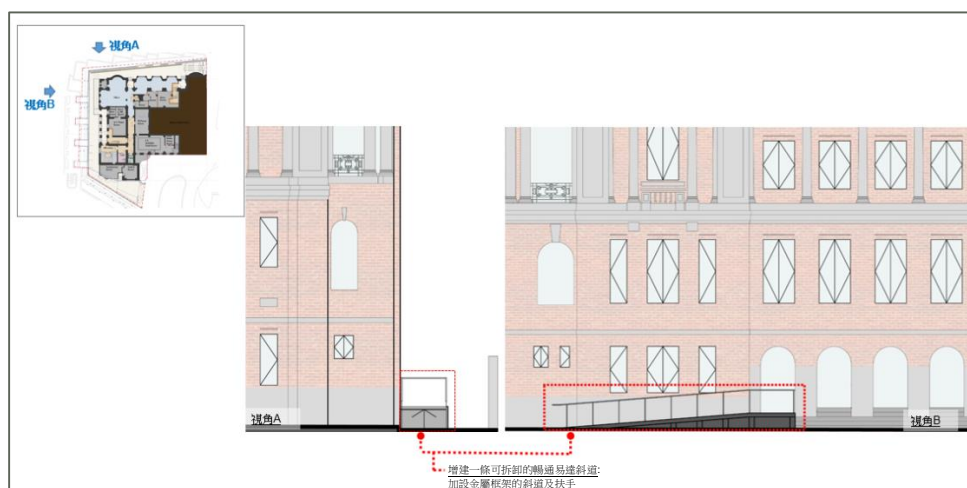
圖 17 增建可拆卸的斜道的建議設計
