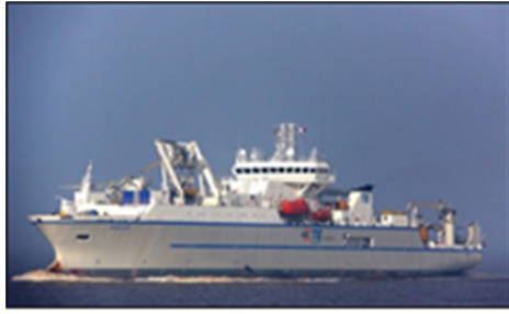
典型的使用雪橇式掩埋器的電纜安裝船/駁船
