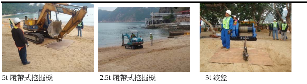
圖 2.6 岸上光纜安裝所需的典型機械設備
