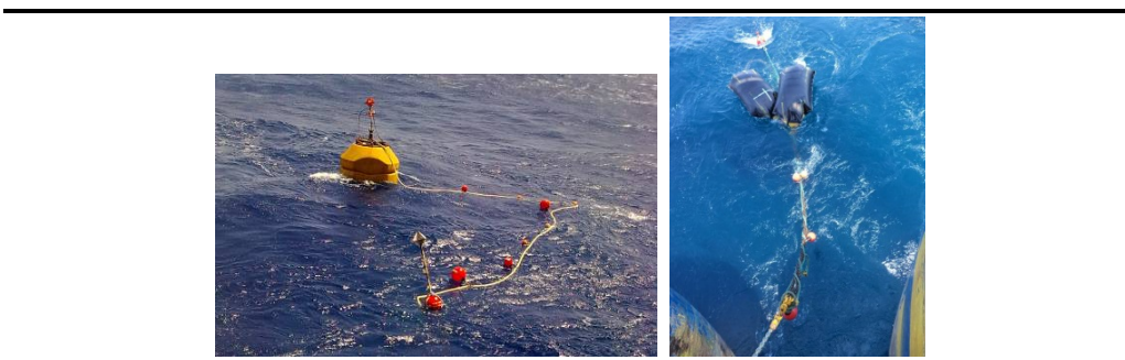
圖 2.18 用作連接光纜終端及繩索的典型浮標類別
