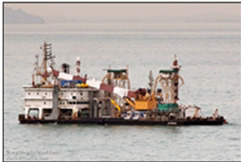
典型的使用沖噴式掩埋器的電纜安裝船/駁船
