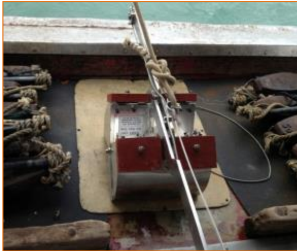
Photo 6-1 Van Veen Grab Sampler
