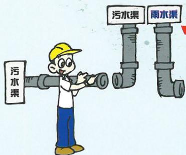
✓ 如需進行渠務工程，須確保承辦商沒有將污水渠錯誤接駁入雨水渠。
