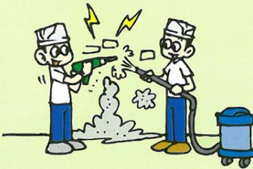
✓ 拆卸牆身或用電鑽鑽孔時，應使用吸塵機防止塵埃飛揚。
