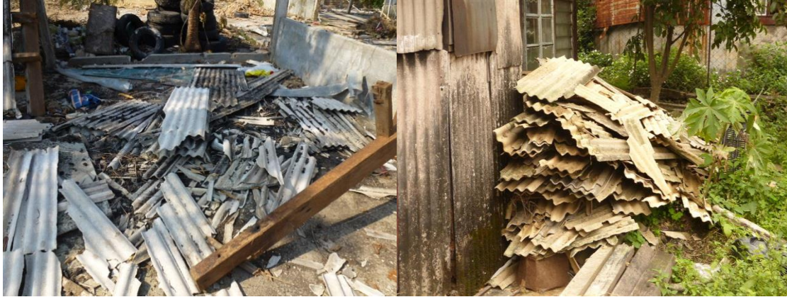
不完整或狀況欠佳的石棉瓦片
