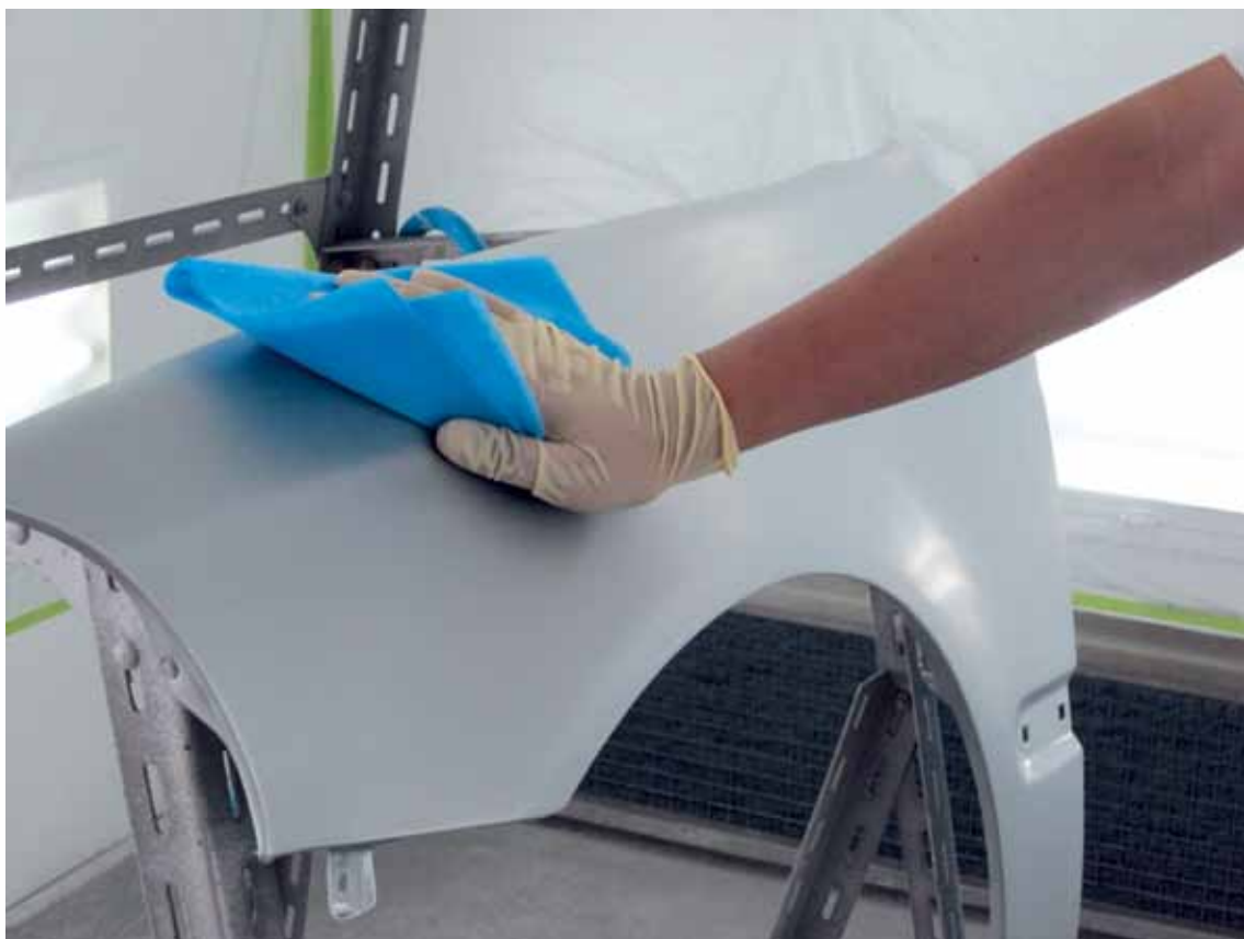
進行一般表面處理工序後及在噴上水溶性漆前，先使用專用的清潔液徹底清潔表面
