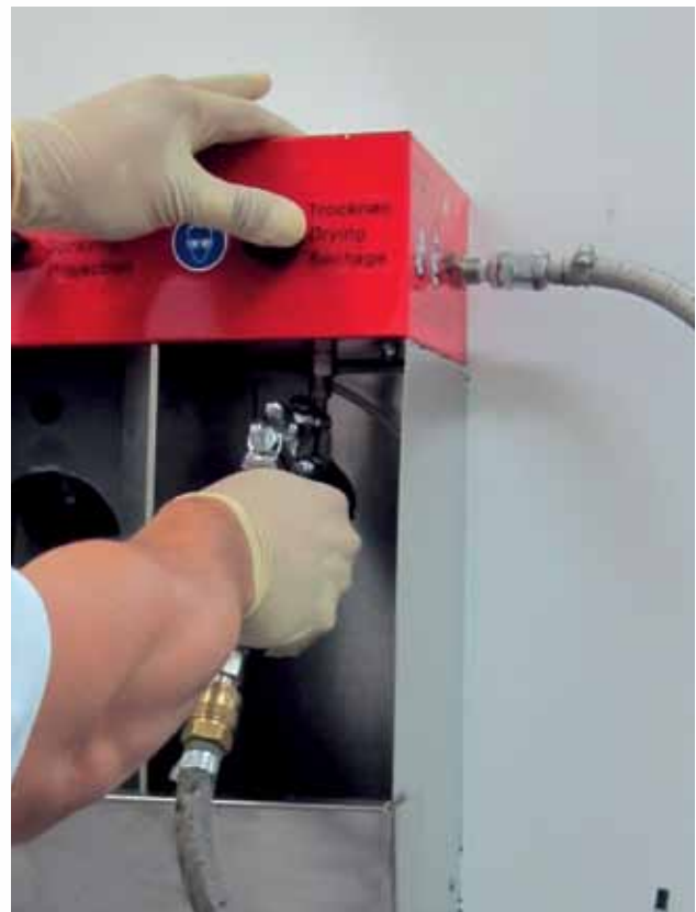
以上噴槍快速清洗機(相片)的左邊是用作清洗用途，而右邊則是用作吹乾噴槍
