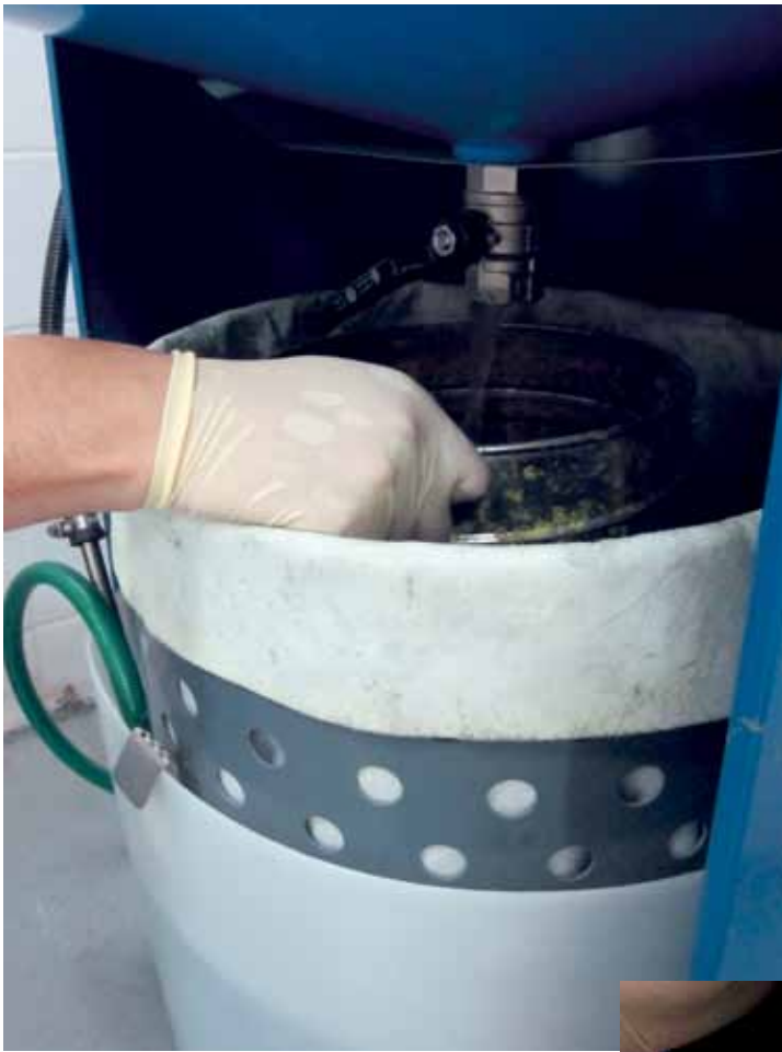
加凝固劑後，再透過過濾器 / 過濾布篩檢殘渣
