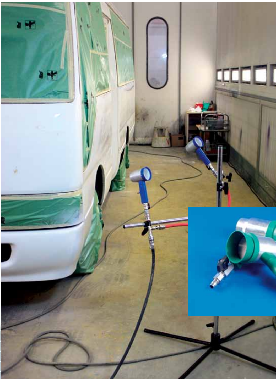
採用手提式或座地式水溶性噴漆吹風槍令車身表面有適當的空氣流速， 縮短水溶性漆料的乾燥時間
