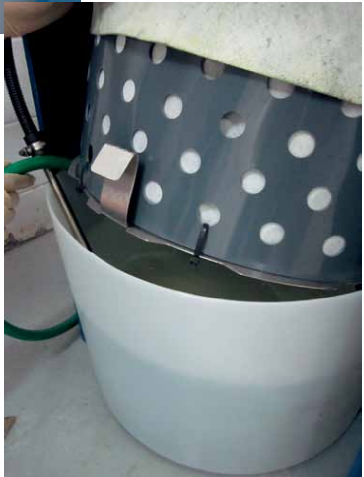
過濾後的廢水可選擇循環再用作 預清洗用途或根據環保署的要求 作工業廢水處理
