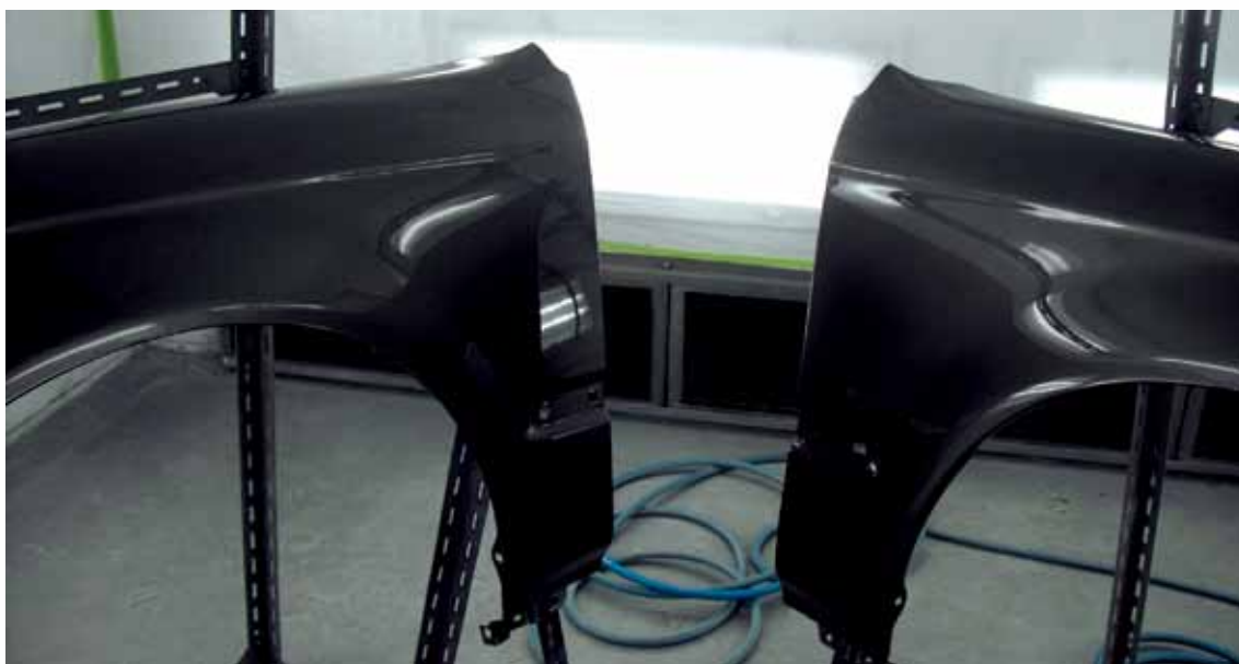
左邊的工件是用水溶性色漆噴塗，右側的工件則用了傳統溶劑性色漆噴塗，兩者的色澤並無甚分別
