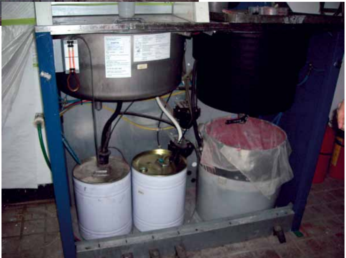
以上雙缸噴槍清洗機(相片)的右側可用來清洗水性漆噴槍，而左邊是用作清洗溶劑性漆的噴槍
