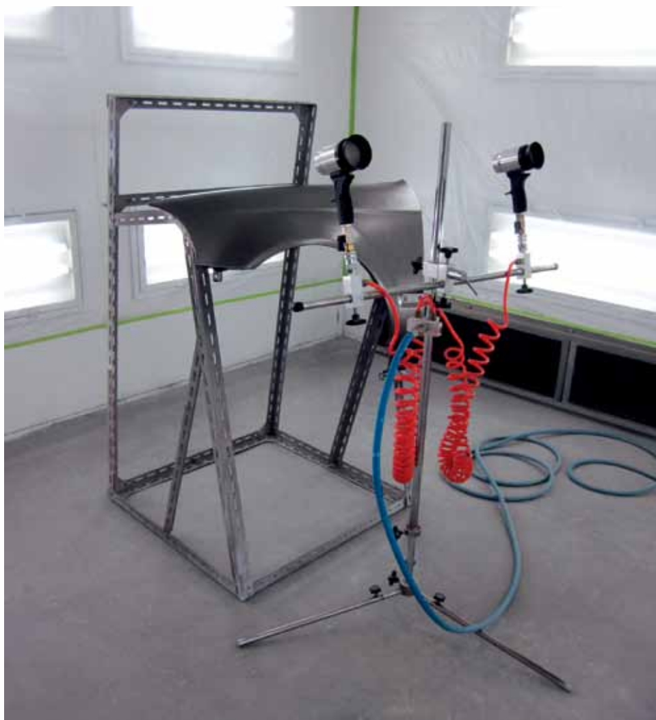
因水溶性漆油揮發性較低，一般需要使用吹風槍加強乾燥效果
