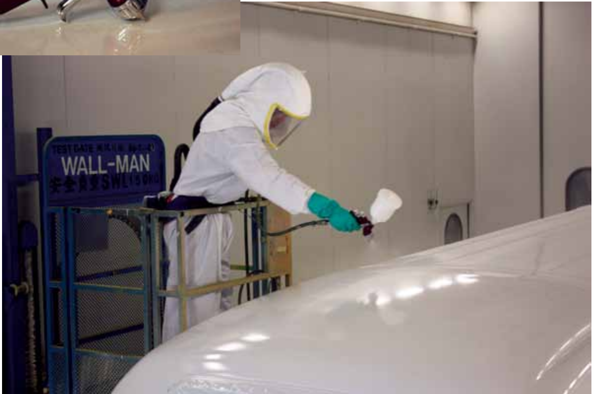
HVLP噴槍的傳遞效率較高，可節約油漆及溶劑，降低成本
