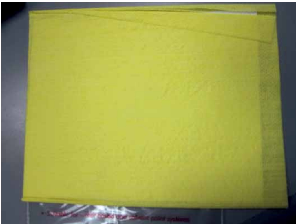
建議採用“黏”度較低的抹塵布清除工件表面上的灰塵，避免造成擦拭痕
