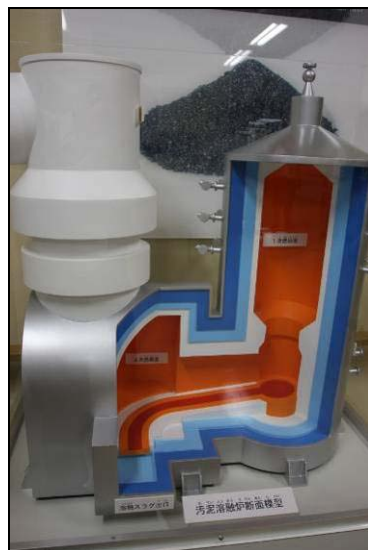
圖三十二、 舞洲污泥中心熔爐的剖切圖
