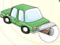
■ 檢查引擎艙隔音 線,確保並無破 損或鬆脫,以保 持隔音效能
