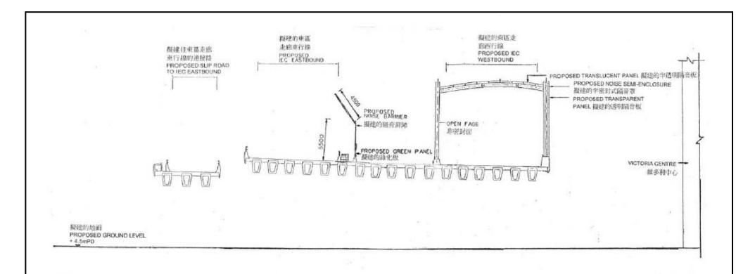
PROPOESD TRUNK ROAD TUNNEL WEST BOUND 擬建的西行線 主幹道隧道
