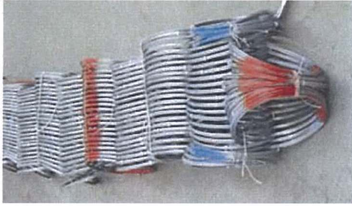
安裝前的柔性防護屏障
