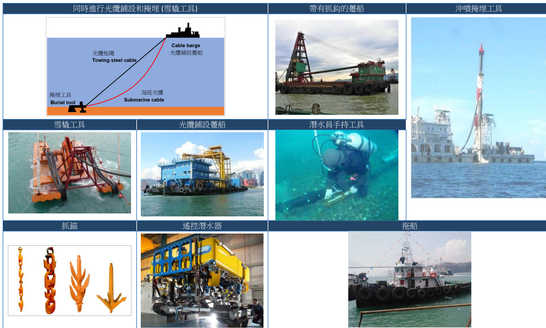
圖 2-4 光纜鋪設船和光纜掩埋工具示例
