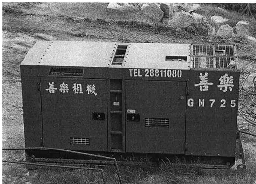
發電機，在距離發電機中心點的 7 米所量度的聲壓級 (A) \leq 75 分貝(A) Generator, with sound pressure level of \leq 75 dB(A) measured at 7 m from the centre of the generator
