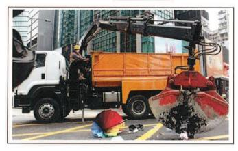
Dump truck with grab, 5.5 tonne<gross vehicle weight  $\leq$  38 tonne 抓斗卸土車 , 5.5 噸< 總重量  $\leq$  38 噸
