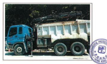
Lorry with grab, 5.5 tonne<gross vehicle weight  $\leq$  38 tonne 抓斗貨車, 5.5 噸<總重量  $\leq$  38 噸
