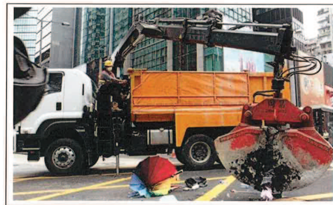
Dump truck with grab, 5.5 tonne < gross vehicle weight \leq 38 tonne 抓斗卸土車，5.5噸 < 總重量 \leq 38噸
