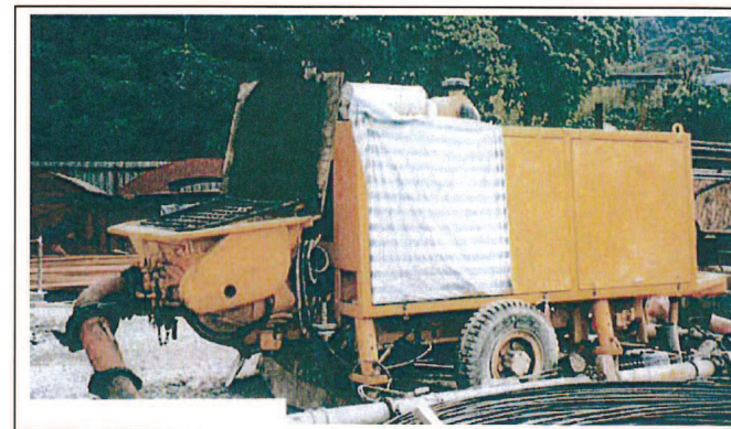
CNP 047 Concrete pump, stationary 混凝土泵，固定
