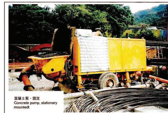
CNP 047 Concrete pump, stationary 混凝土泵，固定
