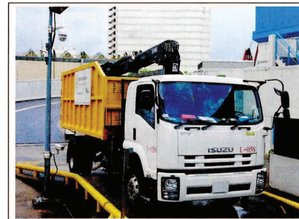
Dump truck, with grab, 5.5 tonne < gross vehicle weight \leq 38 tonne 抓斗卸土車，5.5 噸 < 總重量 \leq 38 噸
