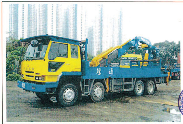
Lorry with crane, 5.5 tonne < gross vehicle weight \leq 38 tonne 吊臂貨車，5.5 噸 < 總重量 \leq 38 噸
