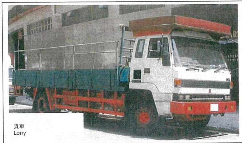
Lorry, 5.5 tonne < gross vehicle weight \leq 38 tonne 貨車，5.5 噸 < 總重量 \leq 38 噸
