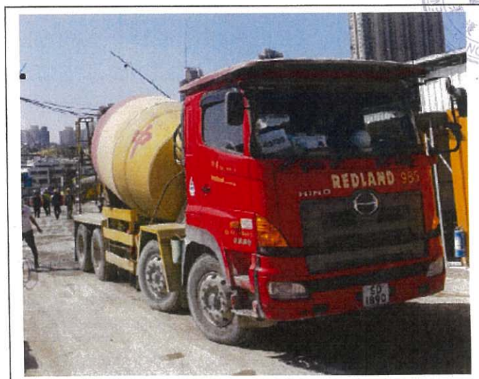
Concrete lorry mixer (Vehicle No. SD1890) 混凝土攪拌車 (車牌號碼 SD1890)
