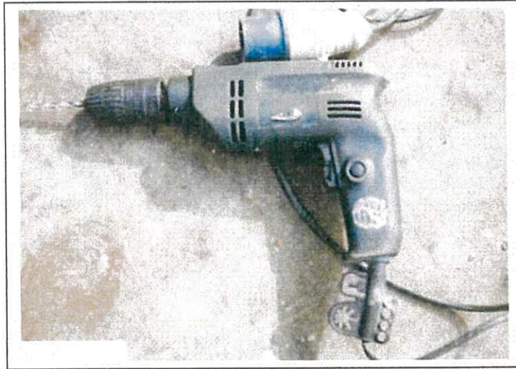
CNP 065 Drill, hand-held (electric) 鑽，手提型（電動）
