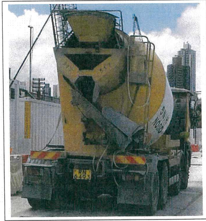
Concrete lorry mixer (Vehicle No. RN6493) 混凝土攪拌車 (車牌號碼 RN6493)
