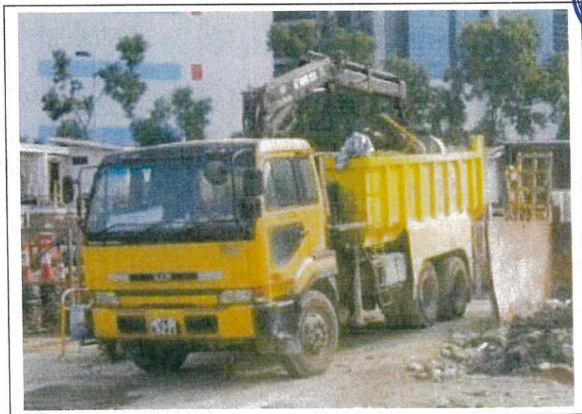
Dump truck, with grab, 5.5 tonne < gross vehicle weight \leq 38 tonne 抓斗卸土車，5.5 噸 < 總重量 \leq 38 噸
