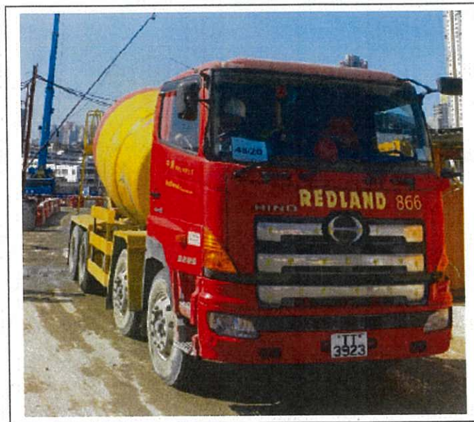
Concrete lorry mixer (Vehicle No. TT3923) 混凝土攪拌車 (車牌號碼 TT3923)
