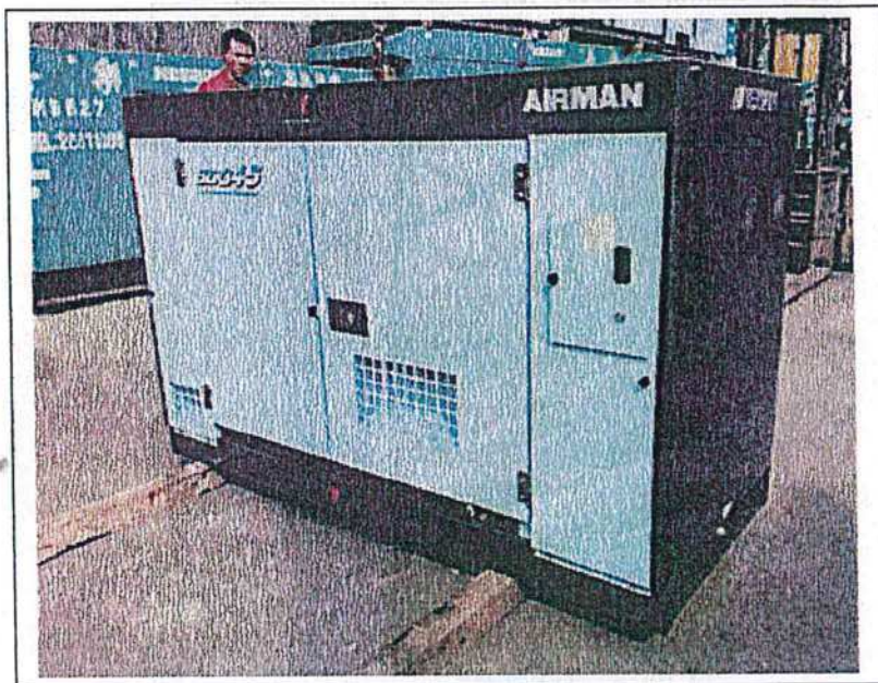
Generator, silenced, \leq 75 dB(A) at 7m 發電機，低噪音型在 7 米距離時 \leq 75 分貝(A)
