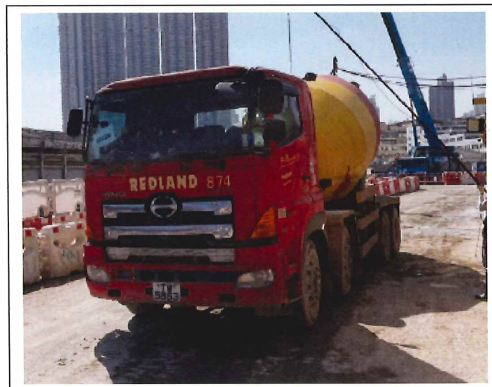
Concrete lorry mixer (Vehicle No. TW5863) 混凝土攪拌車 (車牌號碼 TW5863)
