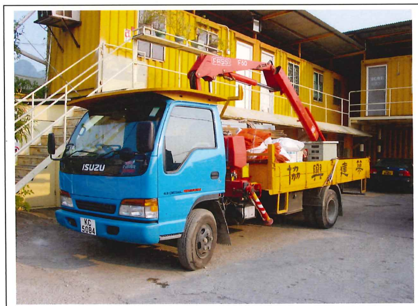
Lorry, with crane, 5.5 tonne < gross vehicle weight \leq 38 tonne 吊臂貨車，5.5 噸 < 總重量 \leq 38 噸
