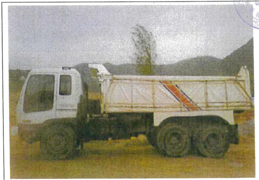
Dump truck, 5.5 tonne < gross vehicle weight \leq 38 tonne 卸土車，5.5 噸 < 總重量 \leq 38 噸
