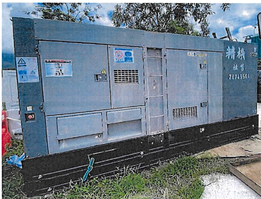
CNP 103 發電機，超低噪音型在 7 米距離時 70 分貝(A) Generator, super silenced, 70 dB(A) at 7 m
