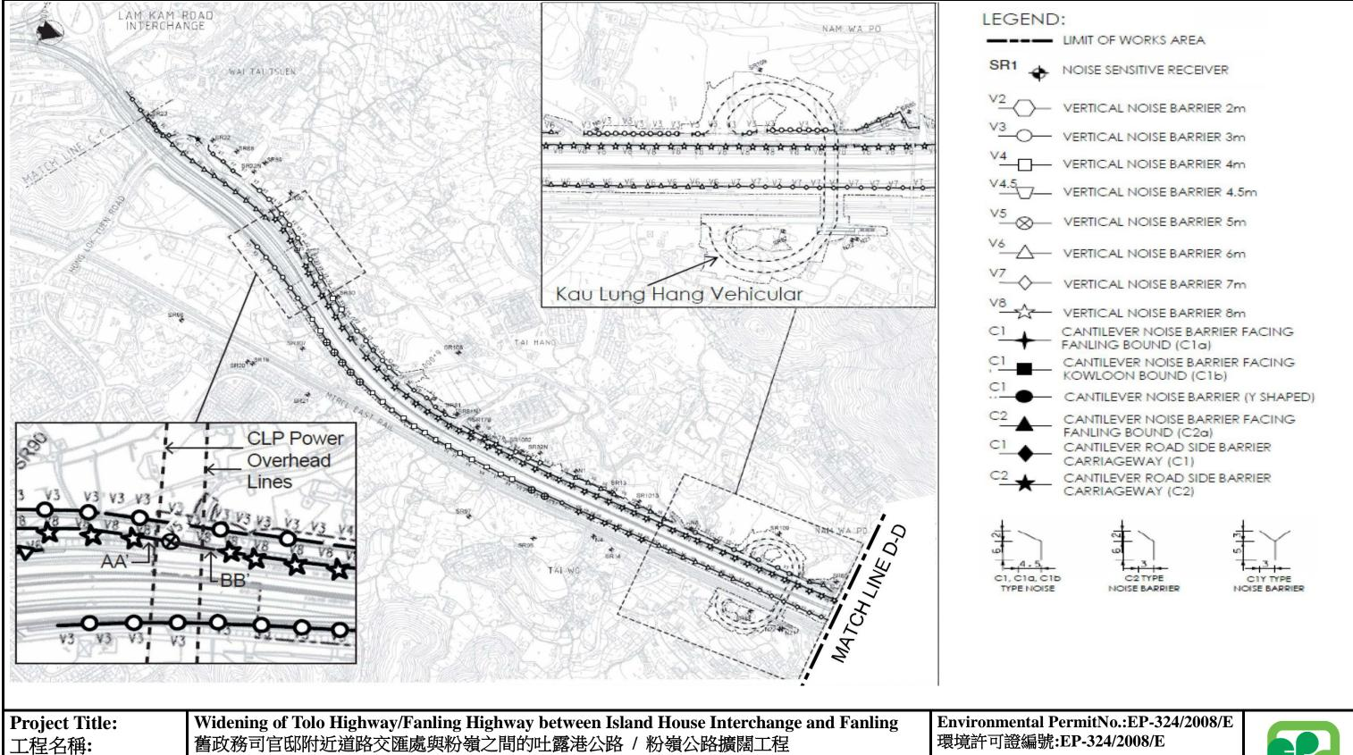
Figure 4d **Layout of Noise Barrier** 圖四 d 隔音屏障圖
