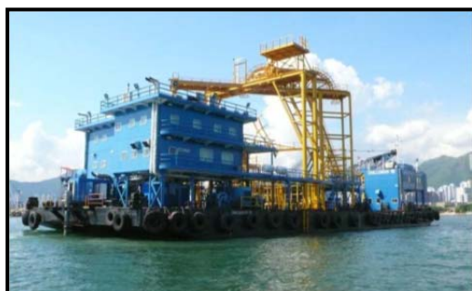
使用雪橇式掩埋器的典型光纜鋪設躉船
