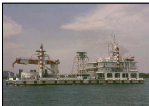
使用沖噴式掩埋器的典型光纜鋪設躉船
