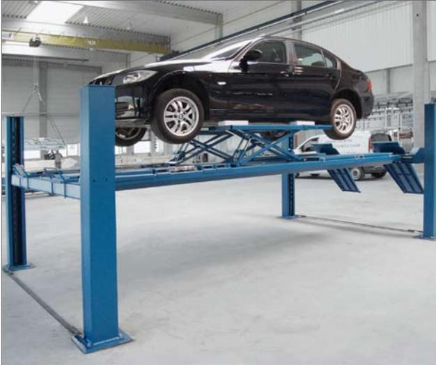
Die Hebebühne hebt Fahrzeuge bis 4500 kg mit einer Hubhöhe bis zu 1840 mm sicher an · The lift lifts vehicles up to 4500 kg safely with a max. lifting height of 1840 mm
