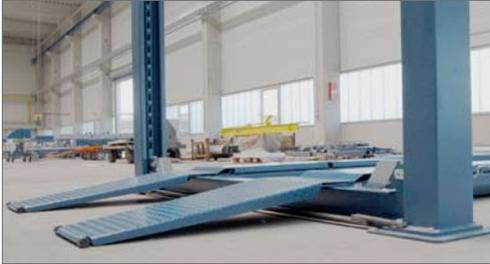
Bequemes Auffahren auch für tiefergelegte Fahrzeuge durch flache Fahrschienen und Auffahrrampen ·
