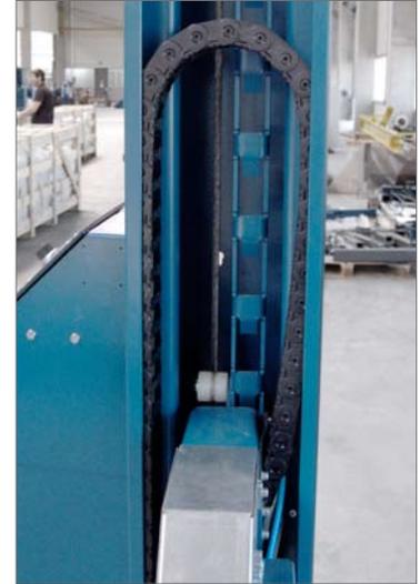
Sicherheit mit feinjustierbarer Klinkenleiste mit sicher geführtem Kabel-in-Kabel-Kanal · *Safety through adjustable ratchet bar*
