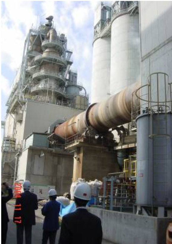
圖 19 太平洋環保英泥廠的旋轉燒窯
