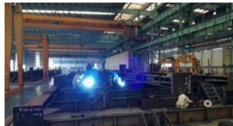
| 为珠海预制工地之机电组件钢构件进行装配及焊接 (2020 年 12 月)
