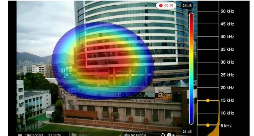
环保署调查人员透过「声学相机」屏幕上呈现的不同颜色，瞬间「看见」最强噪音源。
