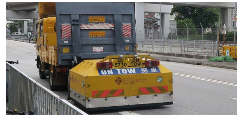
近距离路面噪音测量车在量度路面与轮胎之间产生的噪音
