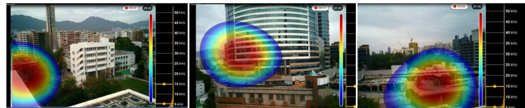
| 「声学相机」屏幕上显示已识别的噪音源
