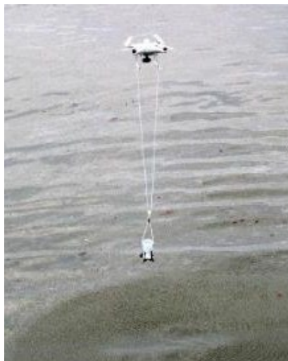
使用自行设计的无人机采样器到偏远地方收集水样本
