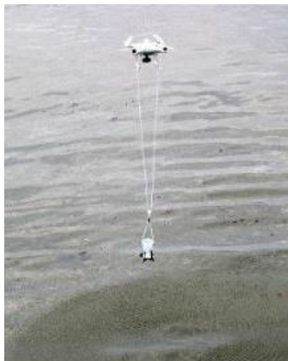
使用自行設計的無人機採樣器到偏遠地方收集水樣本
