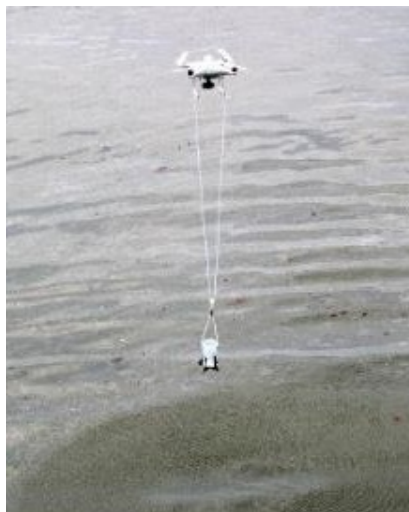
使用自行設計的無人機採樣器到偏遠地方收集水樣本
