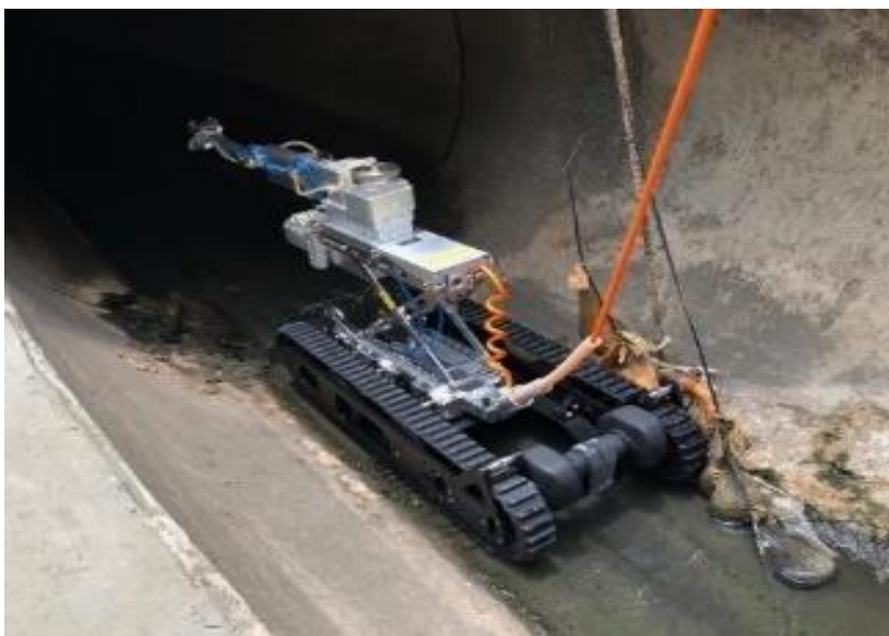
利用可應付不同地形的機械人追蹤地下排水系統的污染情況
