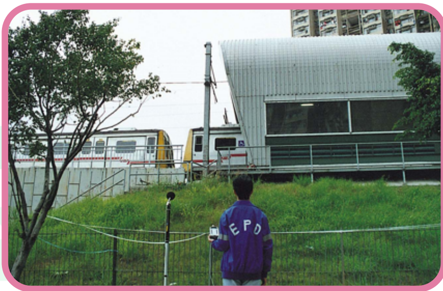
以手持声级计量度铁路噪音
