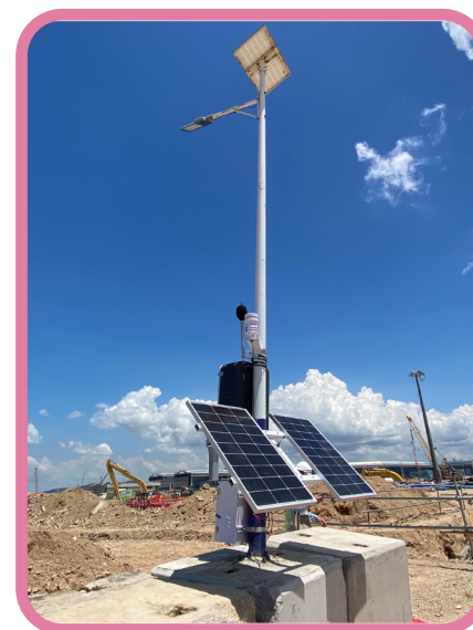
试行设置搭载人工智能模型的太阳能噪音感应器，以分辨建筑噪音与频繁的飞机噪音。 (相片由香港机场管理局提供)
