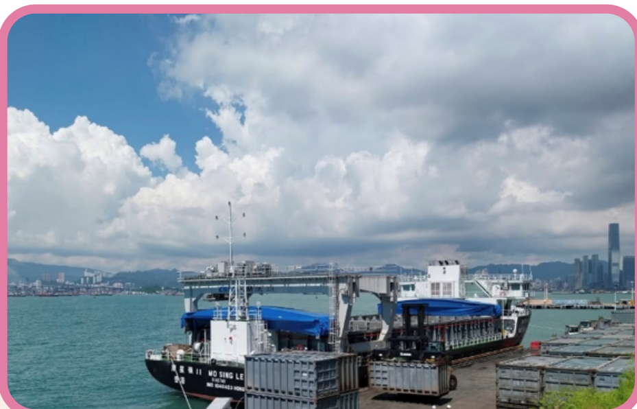
以柴油和电能驱动的新型废物货柜运输船配备轻巧遮盖幕，于港岛西废物转运站停泊。
