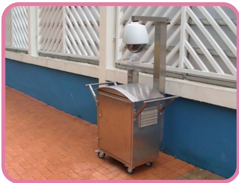
环保署在 2000 年代率先研发的便携式噪音监测系统，具备实时数据传输及影音记录功能。
