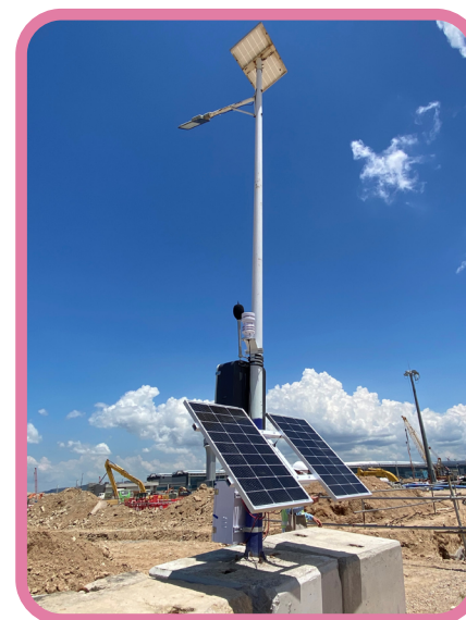
試行設置搭載人工智能模型的太陽能噪音感應器，以分辨建築噪音與頻繁的飛機噪音。 (相片由香港機場管理局提供)
