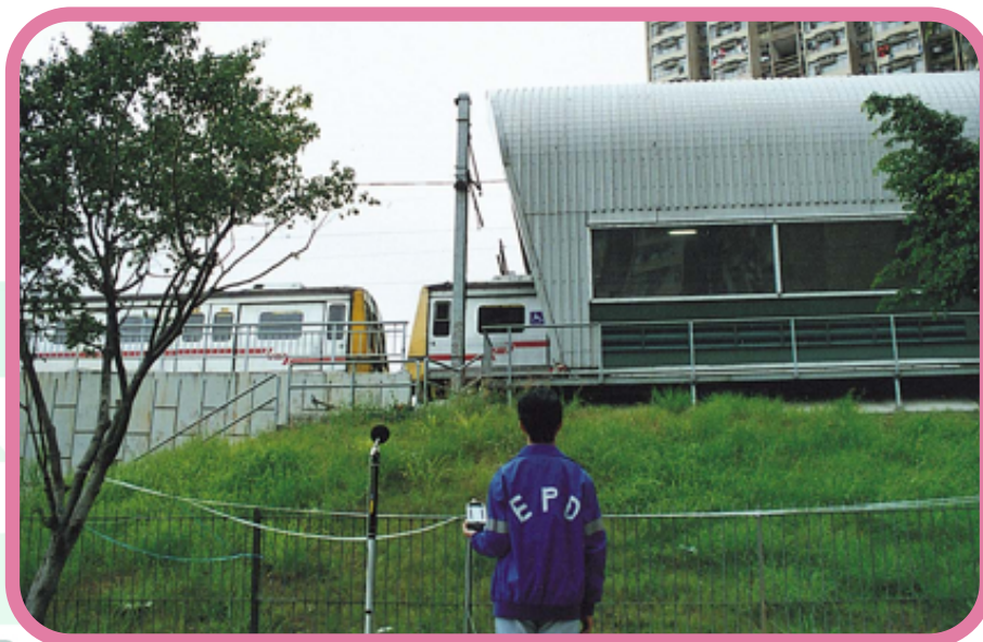
以手持聲級計量度鐵路噪音
