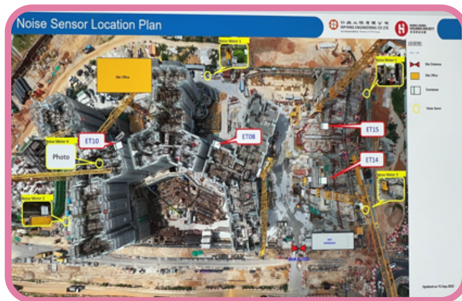
在地盤周邊設置噪音感應器進行持續監測
