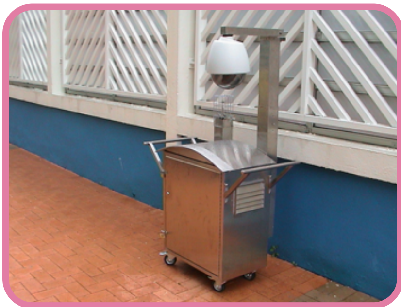
環保署在 2000 年代率先研發的便攜式噪音監測系統，具備實時數據傳輸及影音記錄功能。
