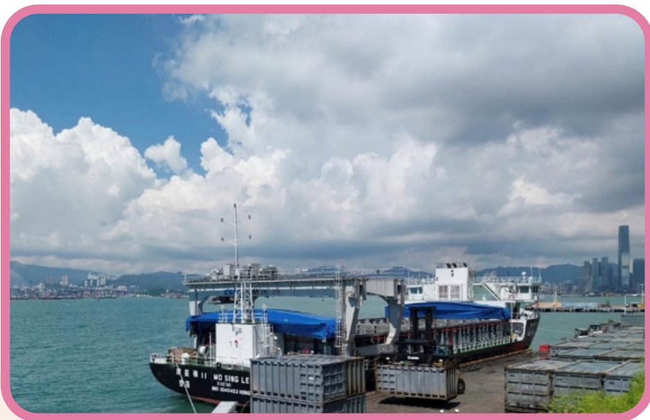
以柴油和電能驅動的新型廢物貨櫃運輸船配備輕巧遮蓋幕，於港島西廢物轉運站停泊。
