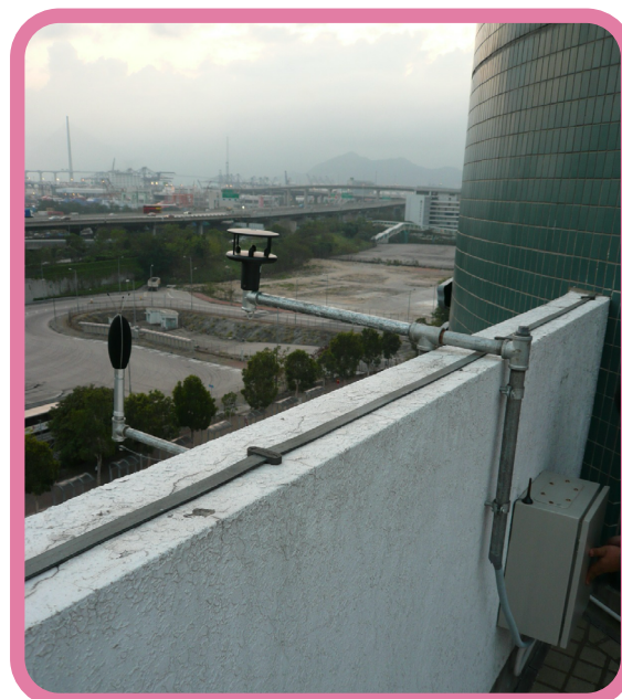
將概念付諸實行—在高鐵香港段持續監測建築噪音。 (相片由香港鐵路有限公司提供)
