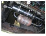
柴油粒子過濾器 Diesel particulate filter?? 柴油氧化催化器 Diesel oxidation catalyst?? 選擇性催化還原器 Selective catalytic reduction??
