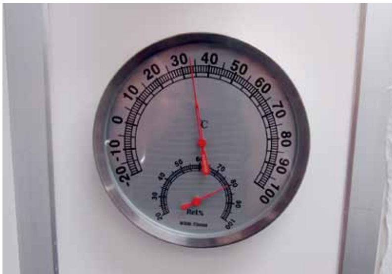
水溶性漆適宜在濕度低的环境施工，建議在噴漆房加設溫度計及濕度計方便監控
