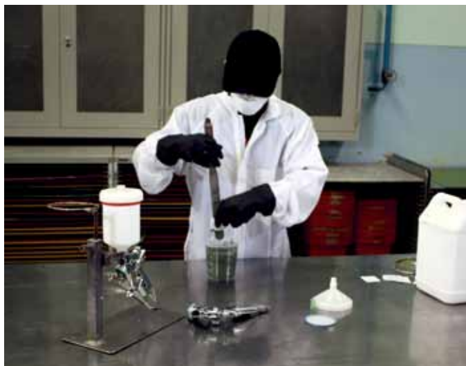
一般水溶性色漆與去離子水混合進行稀釋後，就可以進行塗裝作業
