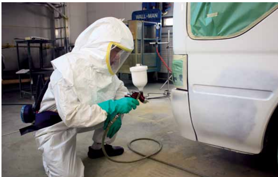
水溶性漆含極低揮發性有機化合物，更能符合《空氣污染管制(揮發性有機化合物)規例》的規定
