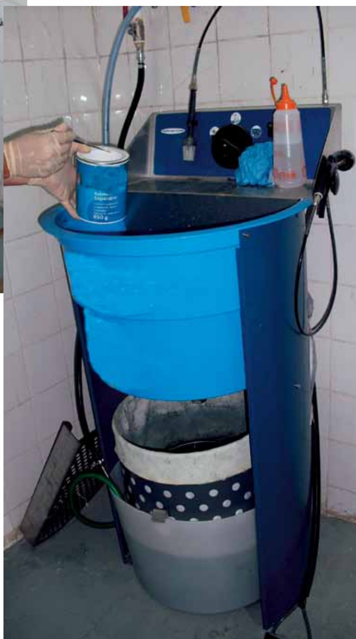
加添少許水溶性漆凝固劑在廢漆水中，以凝結廢水中的污物及雜質，方便處理廢水
