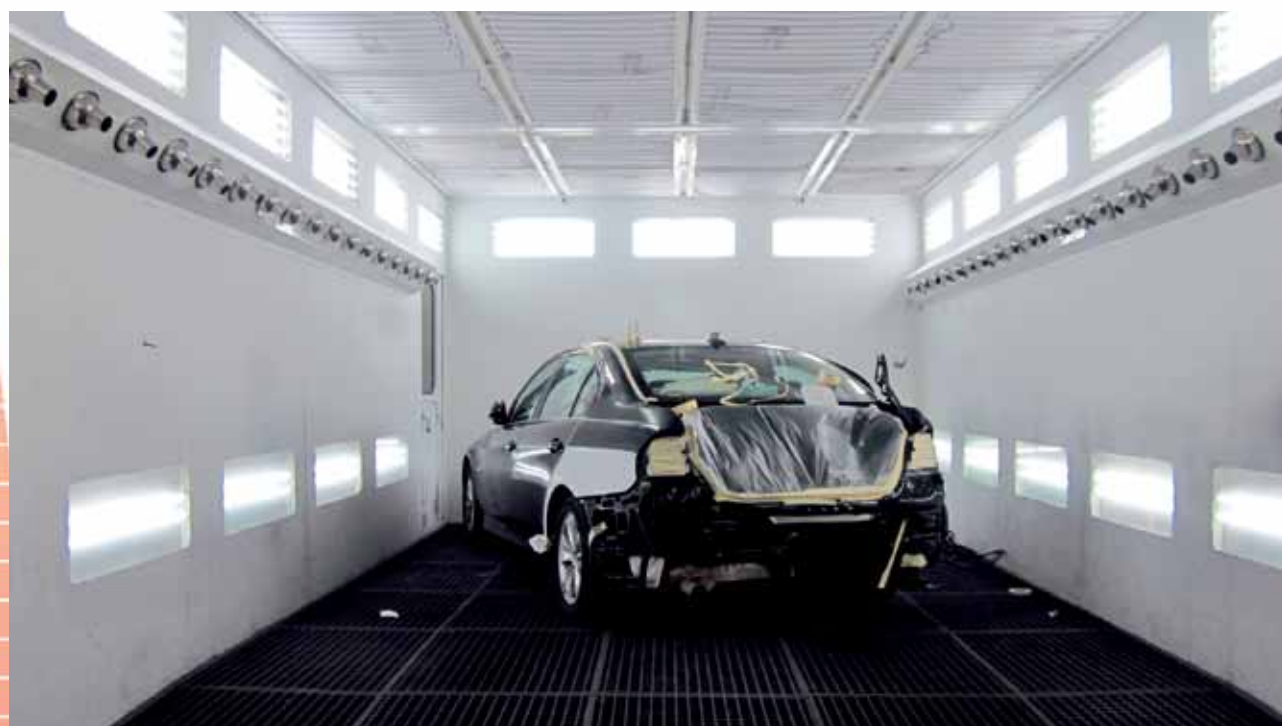
可在噴漆房的牆上頂部安裝吹風嘴系統（一排排的吹風嘴）（建議設置，非必要性），縮短水溶性漆料的乾燥時間
