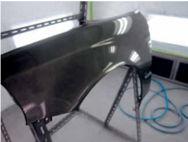
右圖是剛噴完傳統溶劑性色漆後的情況，左圖的工件則是剛噴完水溶性色漆。 可見水溶性漆的漆膜在未經乾燥過程會較濕潤
