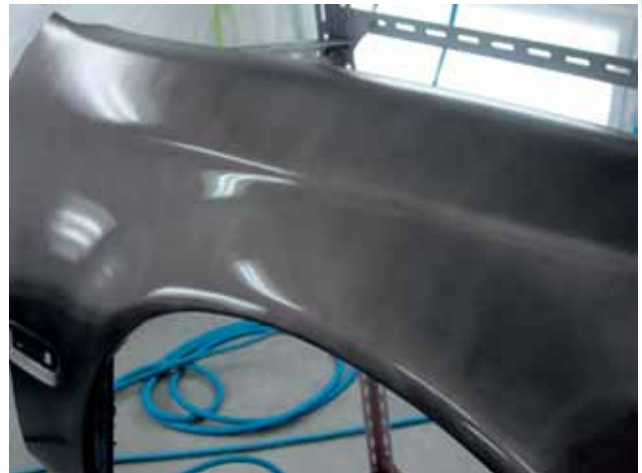
右圖是剛噴完傳統溶劑性色漆後的情況，左圖的工件則是剛噴完水溶性色漆。 可見水溶性漆的漆膜在未經乾燥過程會較濕潤
