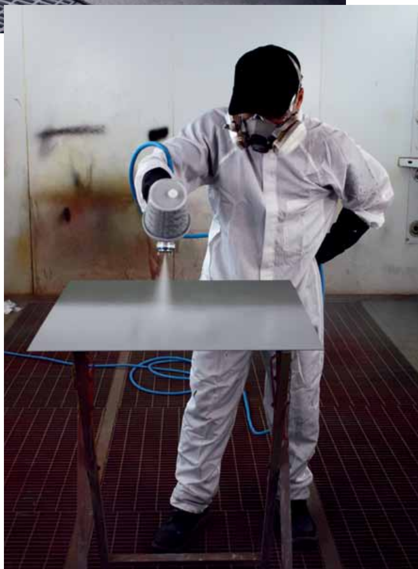
一般HVL噴槍的噴塗距離要求較傳統噴槍稍近
