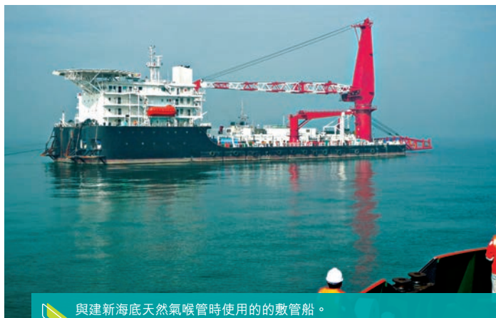
▶ 與建新海底天然氣喉管時使用的的敷管船。 Laybarge for construction of new submarine natural gas pipeline.
