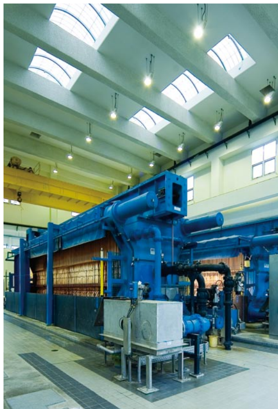
將濾出的廢物製成泥餅的壓濾機。
