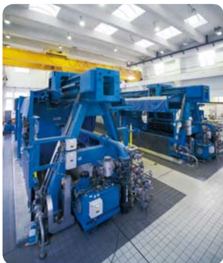
左上：壓濾機是把濾水過程中產生的廢物製成泥餅的裝置。
