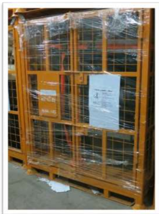
圖 3 - 用作裝載廢顯示器，以塑膠膜圍封的有蓋籠
