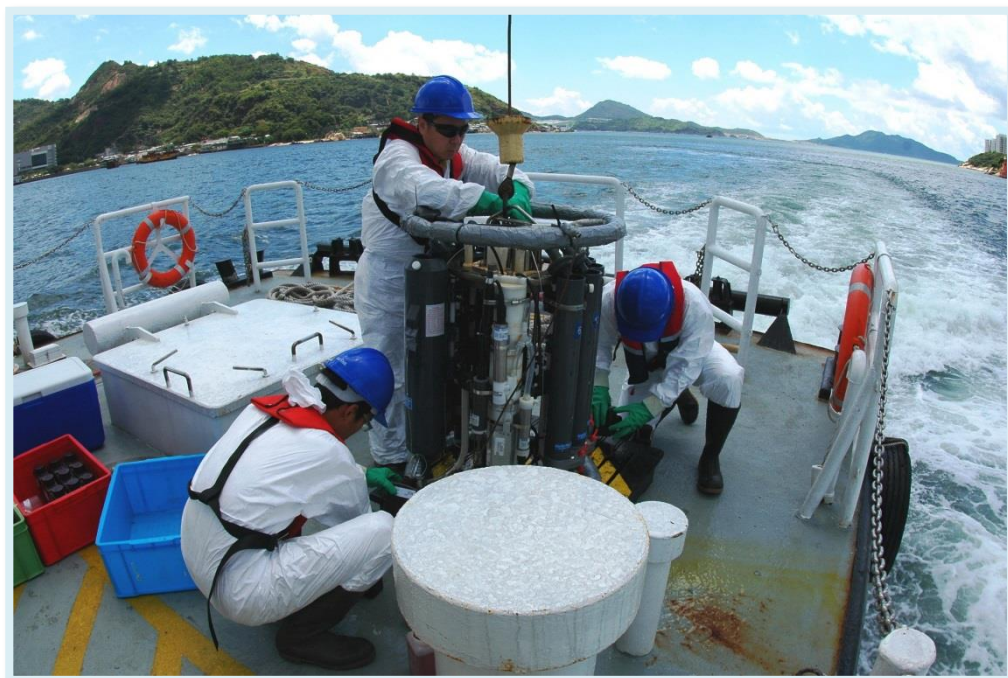
使用计算机控制的多瓶式采样器采水样本
