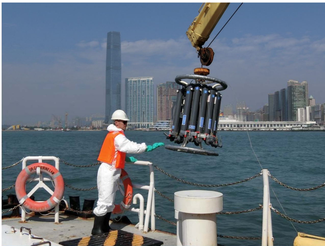
使用电脑控制的多瓶式采样器取水样本
