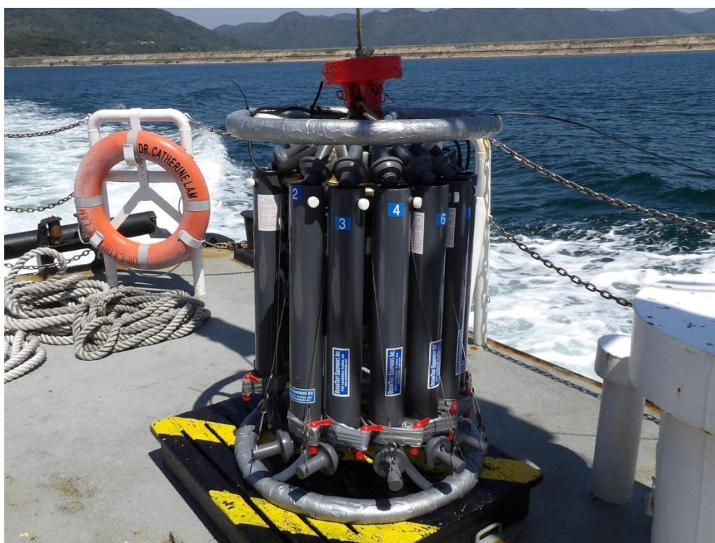
使用计算机控制的多瓶式采样器取水样本
