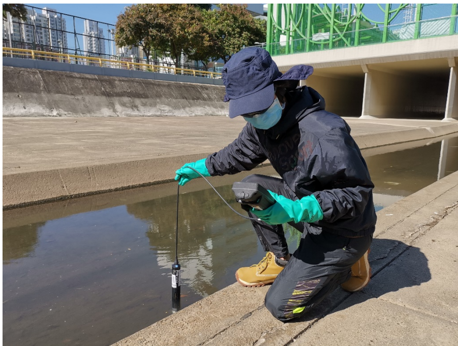
在城门河支流进行实地水质测量
