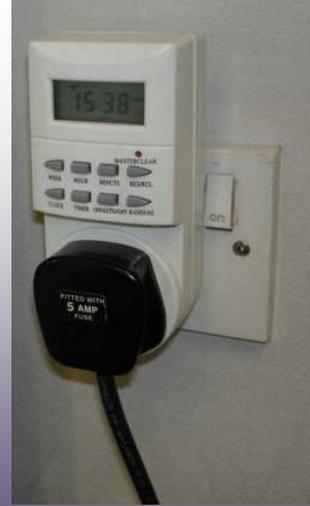
在蒸餾水機安裝7日時間掣，可在辦公時間後自動關掉水機的電源。
