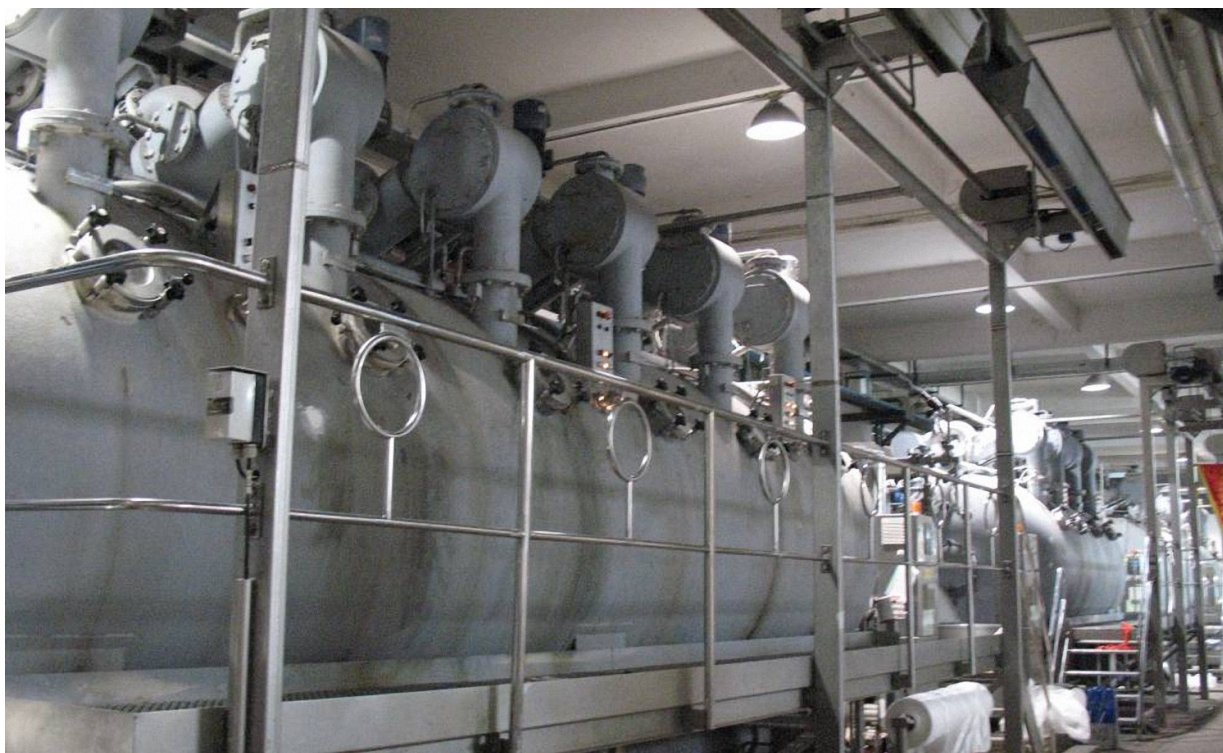
图 3—5 “清洁生产伙伴计划”示范项目—染缸保温减少能耗：至2011年7月，粤港“清洁生产伙伴计划”已经资助1469个项目，帮助企业成功实现了节能减排与经济效益的统一。
