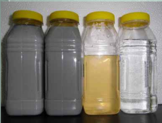
图片1左至右：原液 - 浓缩液90% - UF-19过滤液 - 卷式RO-04过滤液
