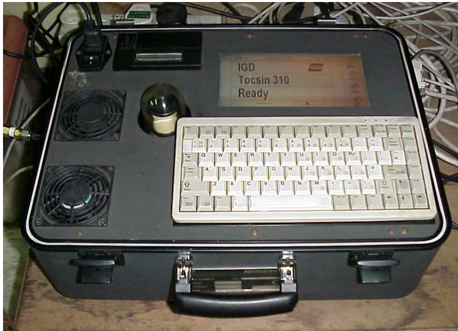
相片 5. Richard Oliver Tocsin 310 一氧化碳及氮氧化物分析儀
