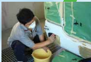
步驟2：車身處理 (扇灰，將不平滑或有裂紋的地方修補；待乾後，打磨，令修補處平滑；再用抹布清潔，去除粉粒)。底灰需要待乾10-30分鐘，然後可以進行打磨。
