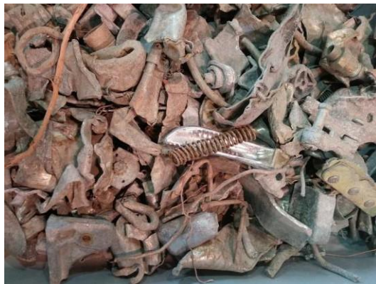
✓✓未受污染鋁回收物料 (裝運前已經分揀且只有少量夾雜物)
