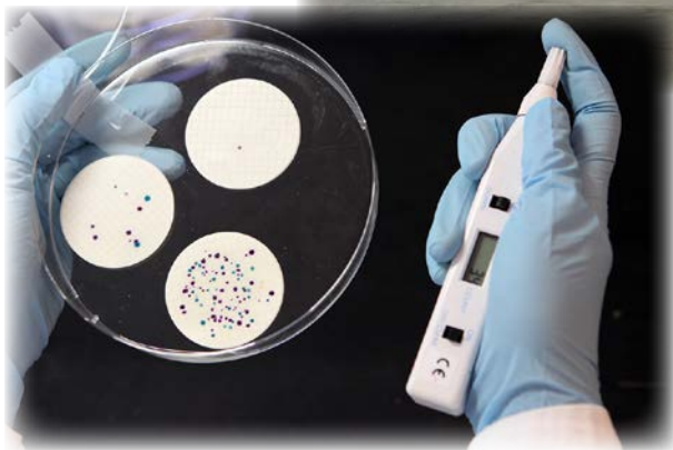
在環保署的化驗室測試 泳灘海水所含的細菌
